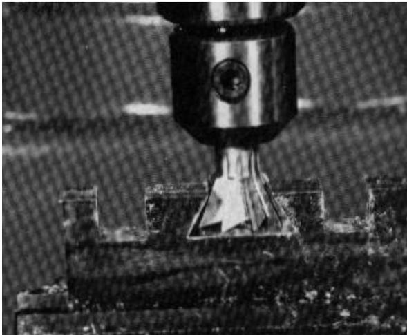
**Figura 25. Fresado de una ranura, con una fresa cola de milano.**
